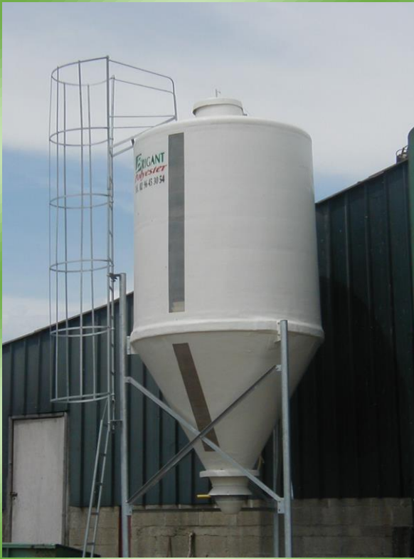
Silo 9 M3 avec trappe sous cône pour vidange dans un chariot
