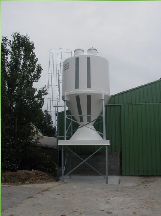
Silo cloisonné D.A.C. de 14,6 m 3 avec double orifice de remplissage
